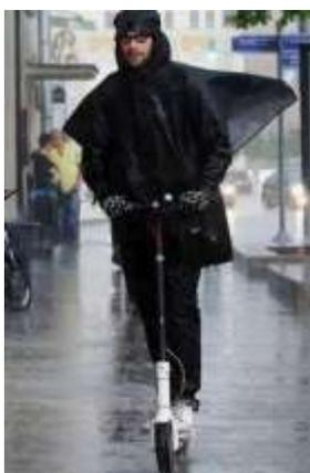
Многие электросамокаты имеют определенный уровень защиты от воды (IP). Они могут работать под дождем и даже ездить по лужам – но не очень глубоким. Попадание воды внутрь двигателя чревато тем, что он выйдет из строя и даже может загореться.
